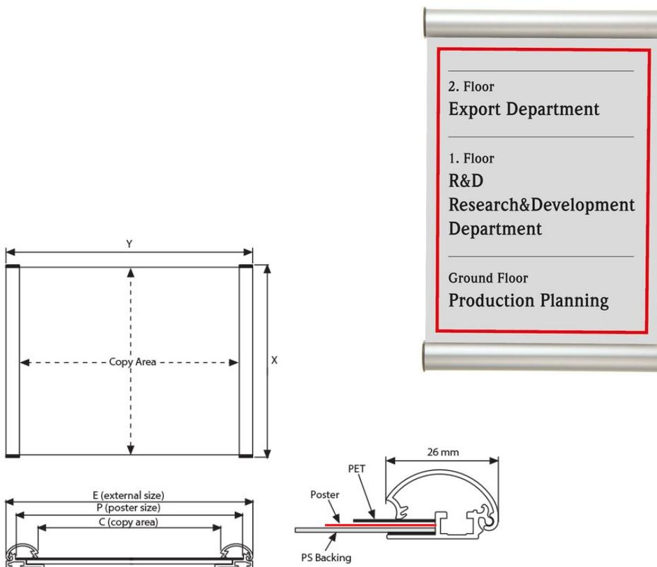
**Targa** con cornice in alluminio spessore 26 mm , chiusura a scatto e lastre di protezione antiriflesso in PET. Applicazione sia con viti che con nastro biadesivo, entrambi forniti in dotazione.
