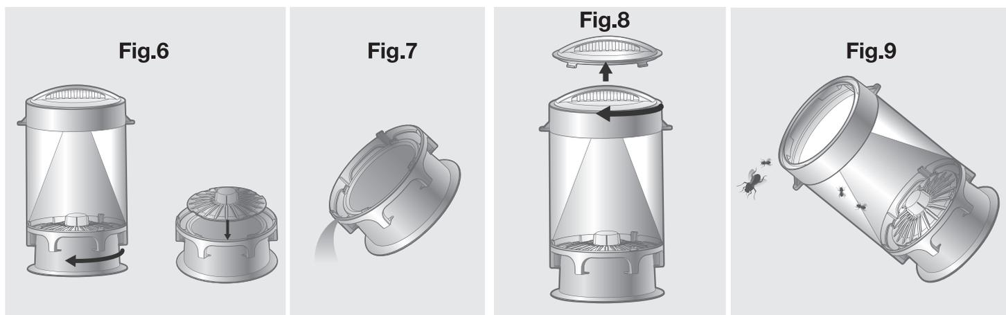
**Quando necessario, provvedere a rinnovare l'esca solubile e svuotare l'apparecchio dalle catture.**
